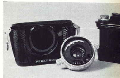
Nikonos skal skilles i tre dele, når filmen skal sættes i. Objektivet og den indre kameradel slutter vandtæt til kamerahuset ved hjælp af O-ringe og et smøremiddel.
